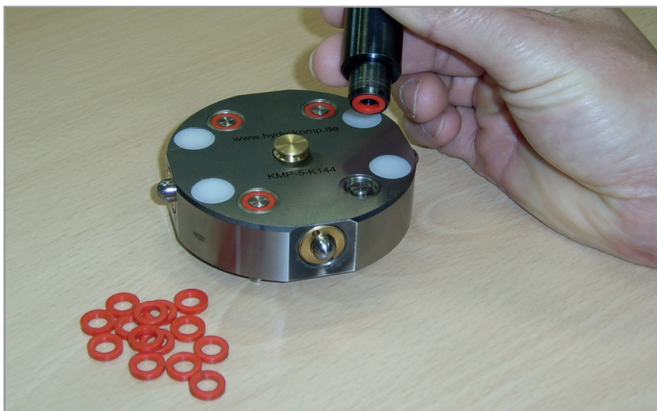
Montagewerkzeug mit Dichtungsring bestückt, vor dem Einpressen in die Kupplungsmechanik
