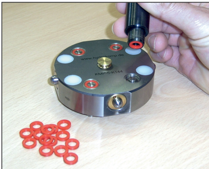
Das mit Dichtungsring bestückte Montagewerkzeug erleichtert und beschleunigt das Austauschen der Dichtungsringe.
