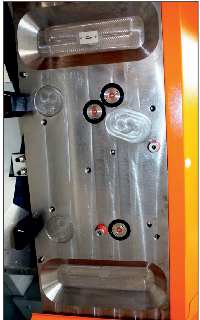
Der Grundkörper der Wechselvorrichtung enthält Kupplungen zum selbsttätigen Öffnen und Schließen der Hydraulikversorgung während der Be- und Entladevorgänge.
