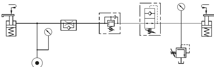
Sollen Drosselventile und Zuschaltventile in Reihe mit dem Druckregelsitzventil kombiniert werden, ist die im Beispiel beschriebene Reihenfolge zu beachten.
