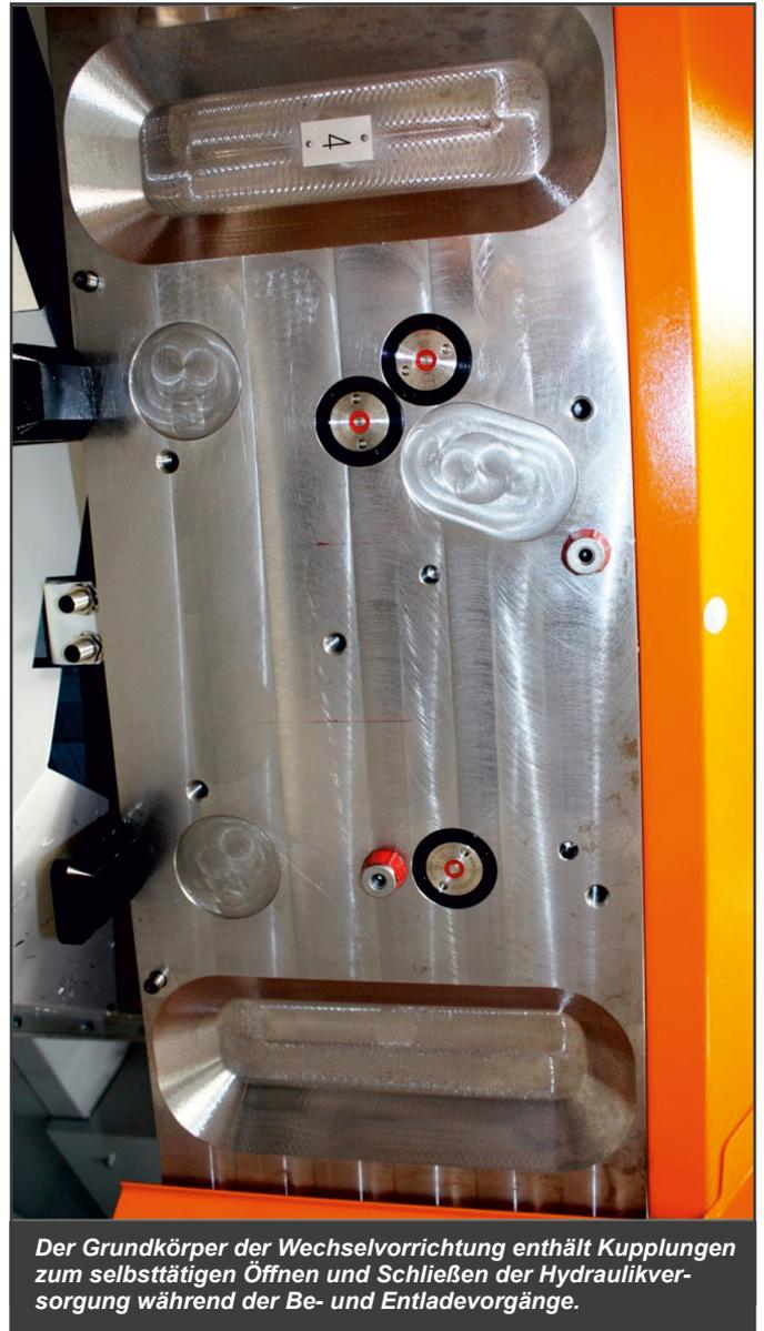
Der Grundkörper der Wechselvorrichtung enthält Kupplungen zum selbsttätigen Öffnen und Schließen der Hydraulikversorgung während der Be- und Entladevorgänge.
