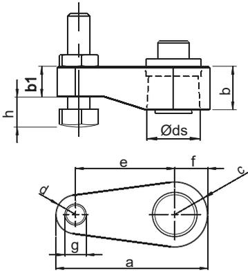
**a** Einfachspannen für Kegelaufnahme, pmax. 350 bar
