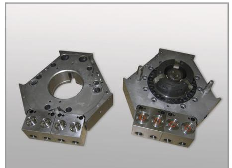
Werkzeugwechselsystem für eine Roboter-Handlingeinheit mit vier Kupplungselementen (Nennweite 8) als Druckölschnittstelle für ein hydraulisch betätigtes Schneidwerkzeug
