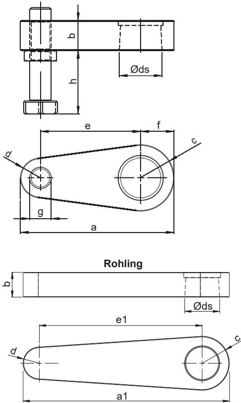
**e** Einfachspanneisen für Kegelaufnahme, pmax. 200 bar
