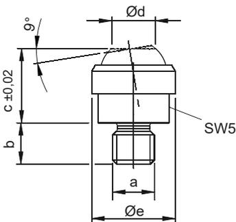
Typ 5: Pendel-Druckschraube, kugelig, Auflagefläche geriffelt
