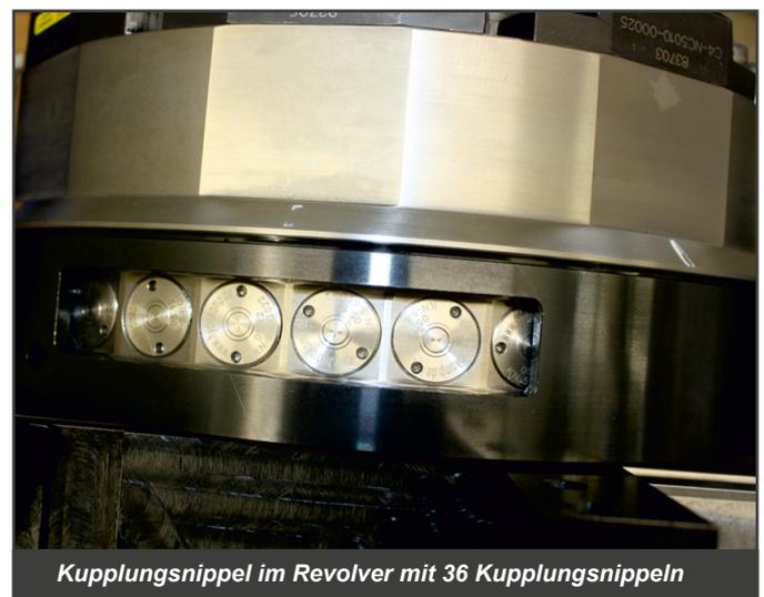
Kupplungsrippel im Revolver mit 36 Kupplungsrippeln
