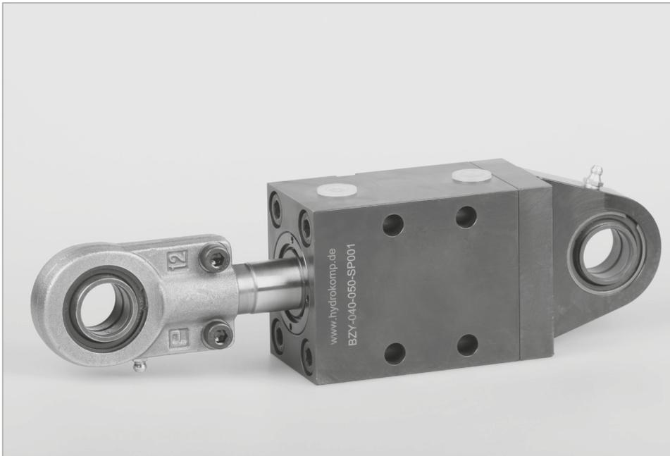
Die Abbildung zeigt einen Blockzylinder mit Kolbenstangen-Außengewinde nebst den Zubehörteilen Gelenkkopf und Lagerbock. Der Lagerbock wird mit vier Zylinderkopfschrauben geliefert und durch die Längsbohrungen am Zylinder montiert.
