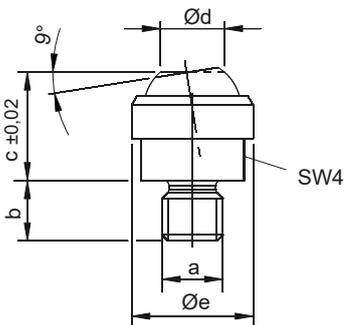
Typ 4: Pendel-Druckschraube, kugelig, Auflagefläche plan
