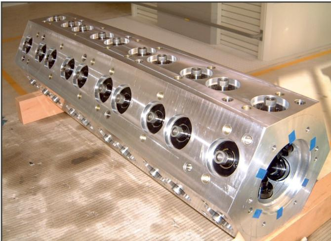
**Einschraubzylinder im Vorrichtungsgrundkörper**
