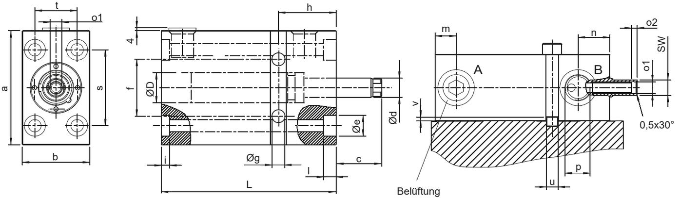
**C** O-Ring Flanschanschluss, Stangenseite
