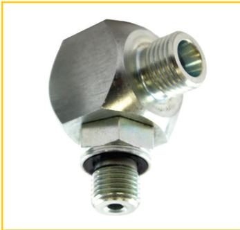
Drehgelenke werden für den Anschluss druckführender Leitungen von einem feststehenden Punkt an rotierende oder schwenkende Maschinenteile eingesetzt. Sie dienen der Verhinderung von Torsion und der Prävention enger Biegeradien bei bewegbaren Leitungen.
