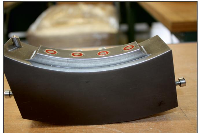
Aufnahmeblock mit automatischen Kupplungsmechaniken
