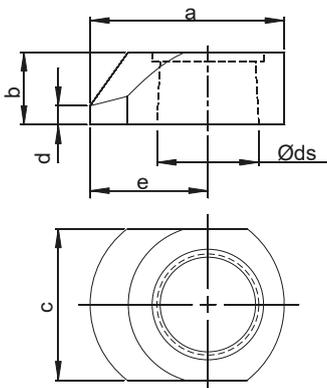
**c** Einfachspannen für Kegelaufnahme, pmax. 500 bar
