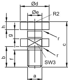
Typ 3: Druckschraube mit Kupplungszapfen, pmax. ziehend 350 bar
