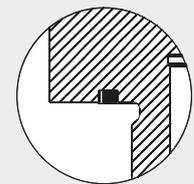
Einschraubzylinder von HYDROKOMP werden durch die am Zylinder angeordnete Dichtkante metallisch abgedichtet. Eine rechtwinklige plangeschliffene Einbaufäche im Vorrichtungskörper ist dazu unerlässlich.
