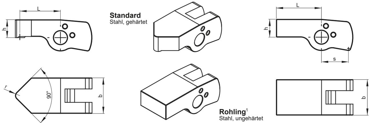
(1) Zur leichteren Bearbeitung bestehen die Rohlinge aus ungehärtetem Stahl. Um eine Verformung im Einsatz zu verhindern, müssen die Spannsen nach der Fertigstellung kundenseitig eingesetzt und gehärtet werden (Härtetiefe: 0,3 +0,2, Härte: HRC 50 +/-2)
