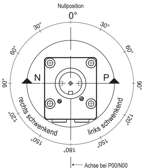
Bei der Bestellung der Schwenkspanner kann die Nullposition der Achse in 30°-Schritten positiv oder negativ bis 180° ausgewählt werden.
