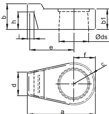
**d** Einfachspannen für Kegelaufnahme, pmax. 300 bar
