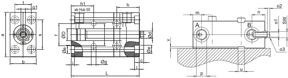
**C** O-Ring-Flanschanschluss Stangenseite
