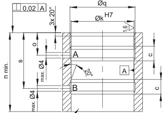
Falls die Einbaubohrung als Sackloch ausgeführt wird, muss eine Entlüftungsbohrung vorgesehen werden.
