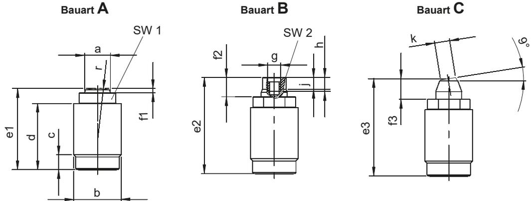
Einschraubzylinder mit Federrückstellung und Doppelabstreifer
