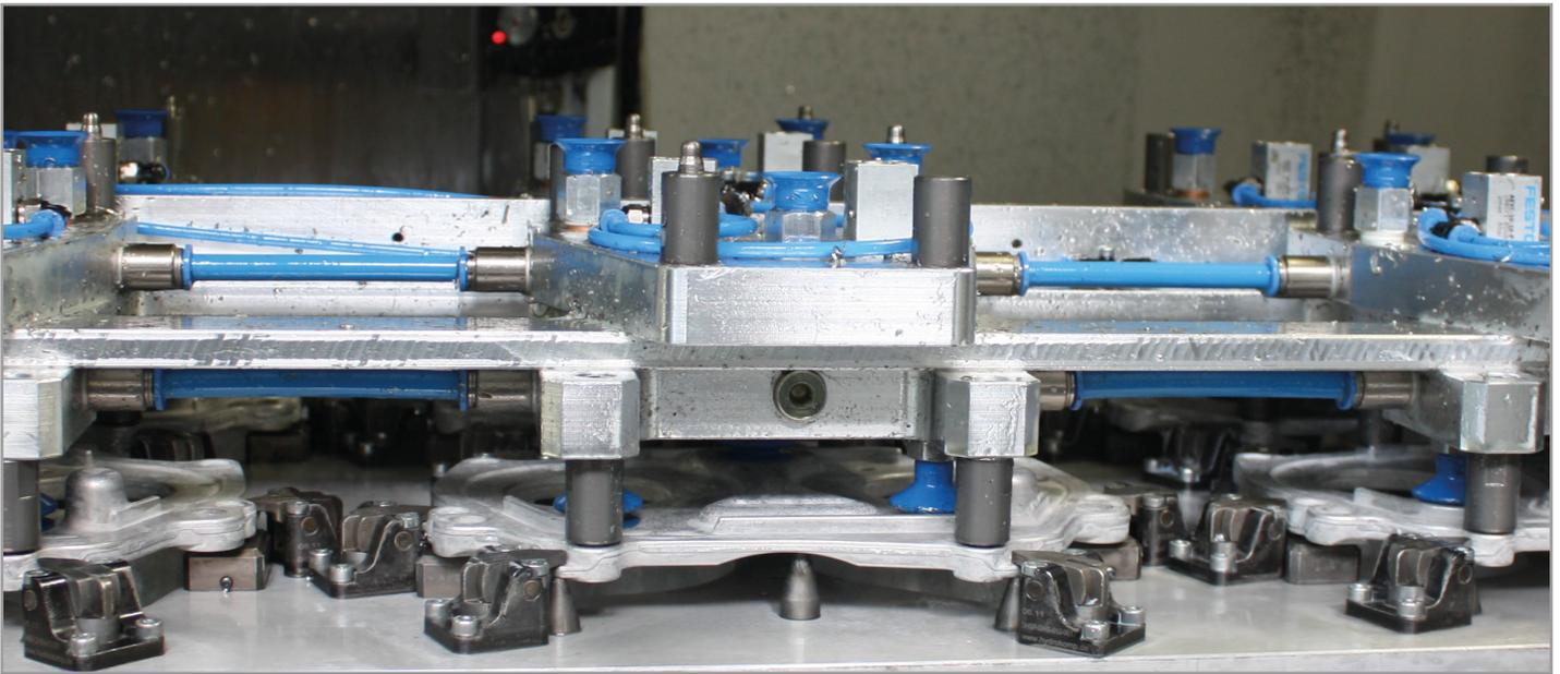
**Mehrfachspannvorrichtung mit doppelt wirkenden Drehhebelspannern mit Kolbendurchmesser 12 mm.**
