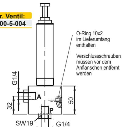
Bei dieser Variante kann am Anschluss **A** ein Manometer angeschlossen werden. (siehe Datenblatt 600-3)
