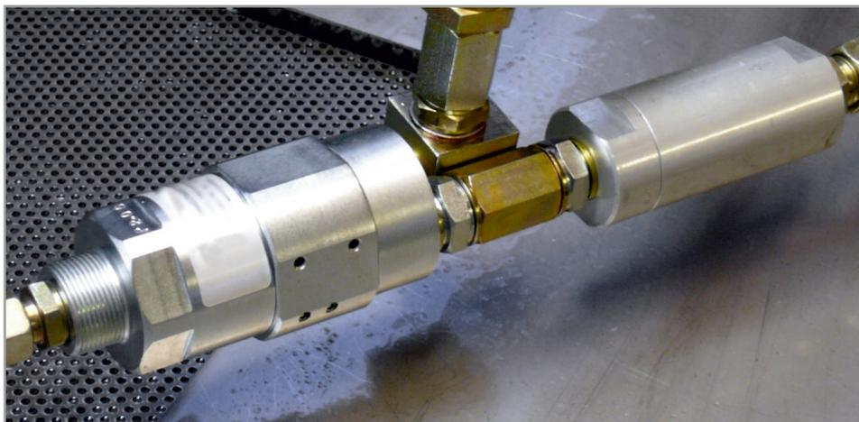
Der Hydraulikfilter wird eingesetzt, um einen hydr./hydr. Druckübersetzer vor Verschmutzung zu schützen. Der Filter ist im Zulauf zu einer hydraulischen Spannvorrichtung montiert und filtert das zulaufende Drucköl. Sinnvoll ist es auch, das ablaufende Drucköl mit einem zweiten Filter zu säubern, um Ventile und andere hydraulische Steuergeräte zu schützen.
