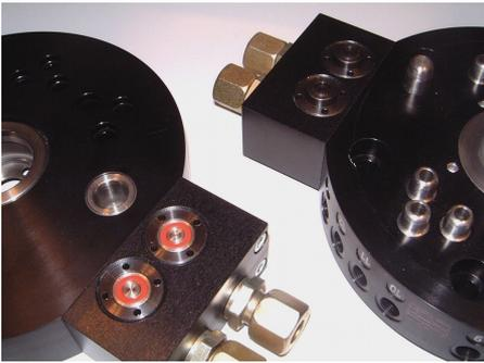
Kupplungselemente zur leckagearmen Druckölübertragung in Werkzeugwechselmodulen eines Roboters, bei denen zwei Hydraulikleitungen über Einschraubkupplungen (M24x1,5) gekuppelt werden.
