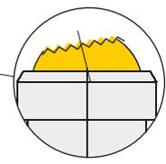
Typ 5: Pendel-Druckschraube, Kugelauflegelfläche geriffelt
