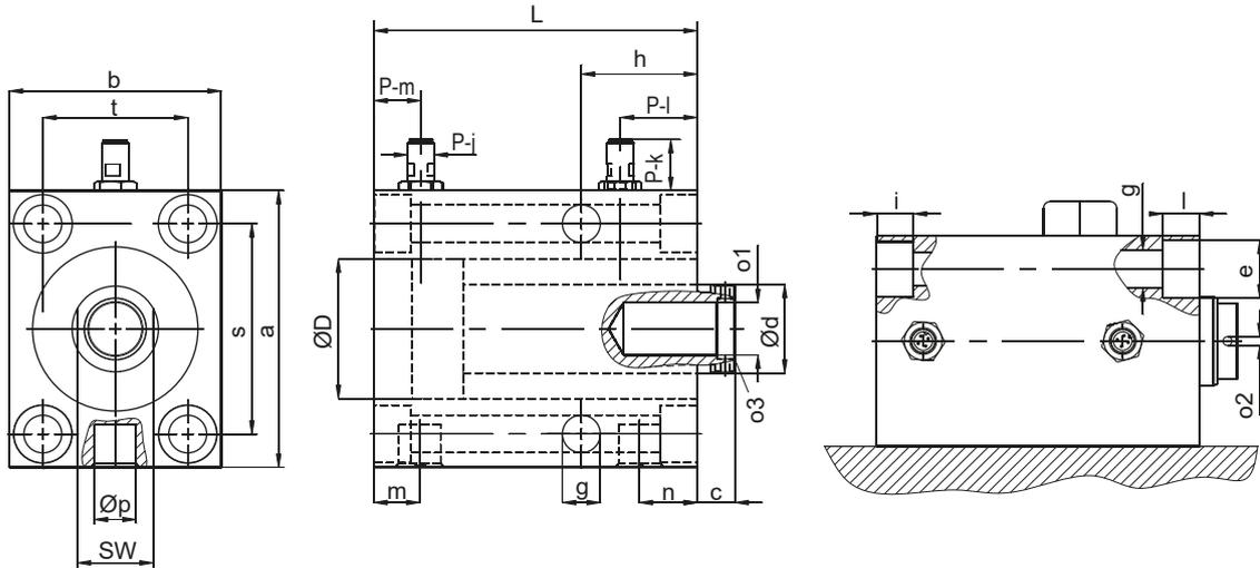
**D** O-Ring Flanschanschluss, Bodenseite
