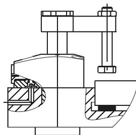
Anwendungsspezifisch kann der Rohrgewindeanschluss oder der O-Ring-Flanschanschluss genutzt werden.
