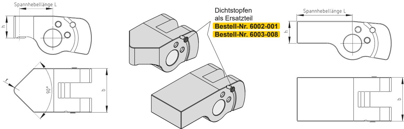
(1) Zur leichteren Bearbeitung bestehen die Rohlinge aus ungehärtetem Stahl.
