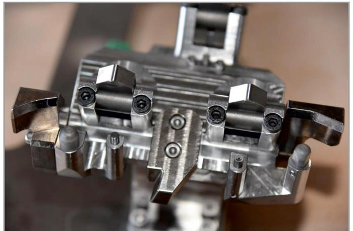
**Pneumatisch betätigte Drehhebelspanner in doppelt wirkender Funktion mit zum Teil gekröpften Sonderspannhebeln.**
