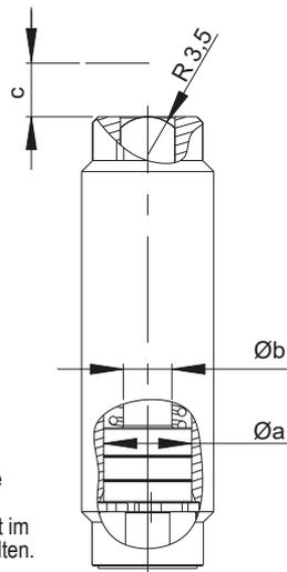
Der Kantseal für die Abdichtung in der Gewindebohrung ist im Lieferumfang enthalten.
