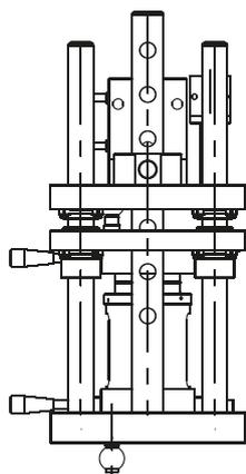
Prüfvorrichtung für Kupplungssysteme
