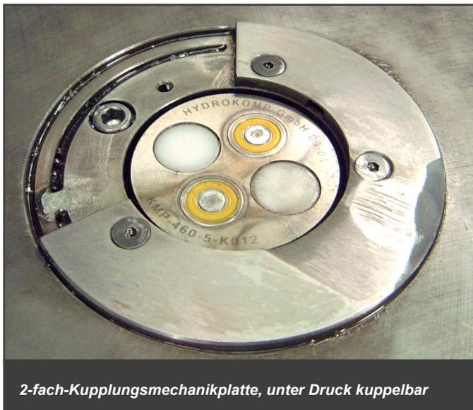
2-fach-Kupplungsmechanikplatte, unter Druck kuppelbar
