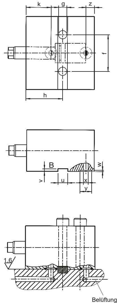
**ACHTUNG:** Es ist darauf zu achten, dass keine Flüssigkeiten oder Fremdkörper über die Belüftung in den Federraum eindringen!
