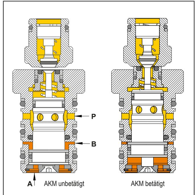
Funktionsschema der Automatischen Kupplungsmechanik (AKM)
