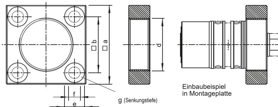
Die Montageplatten erlauben die Befestigung der Zylinder mit vier Schrauben. Das Montagegewinde (Seite 2, Maß "c") entfällt somit. Die Einbauabmessungen kürzen sich um das Maß "i" (siehe Tabelle, Seite 2).
