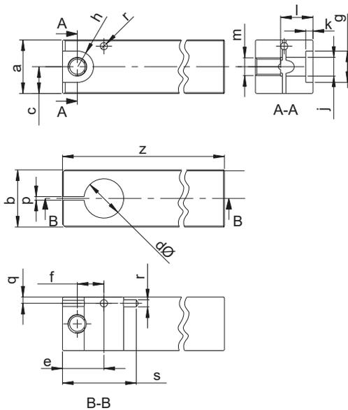
**j** Einfachspanneisen für Zylinderaufnahme, pmax. 70 bar
