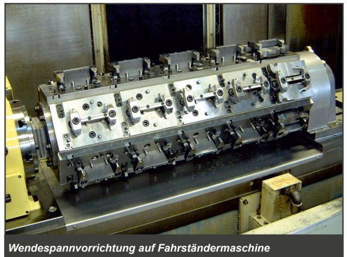
**Wendespannvorrichtung auf Fahrständemaschine**
