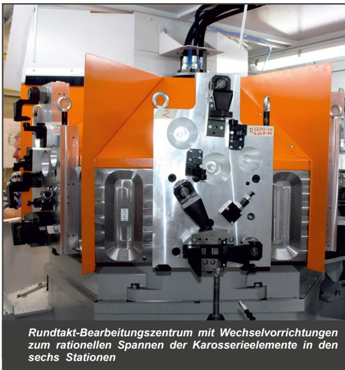
Rundtakt-Bearbeitungszentrum mit Wechselvorrichtungen zum rationellen Spannen der Karosserieelemente in den sechs Stationen
