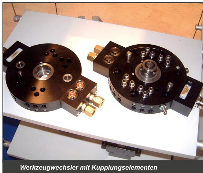
Werkzeugwechsler mit Kupplungselementen
