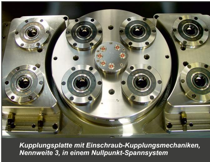
*Kupplungsplatte mit Einschraub-Kupplungsmechaniken, Nennweite 3, in einem Nullpunkt-Spannsystem*
