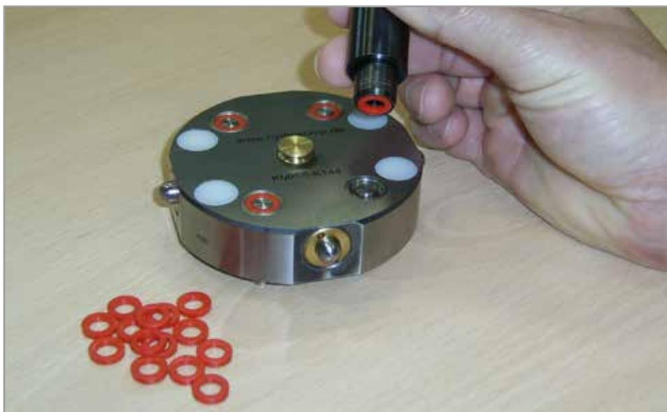
Montagewerkzeug mit Dichtungsring bestückt, vor dem Einpressen in die Kupplungsmechanik
